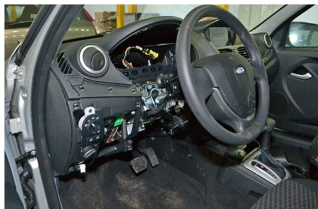
Фото 1.16. Панель приборов снята
